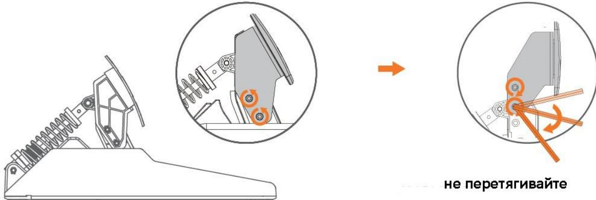
1. Ослабьте и достаньте два винта с помощью шестигранного ключа.
